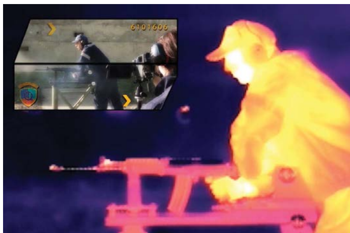
Снимање испитивања стрелачког оружја термовизијском камером
