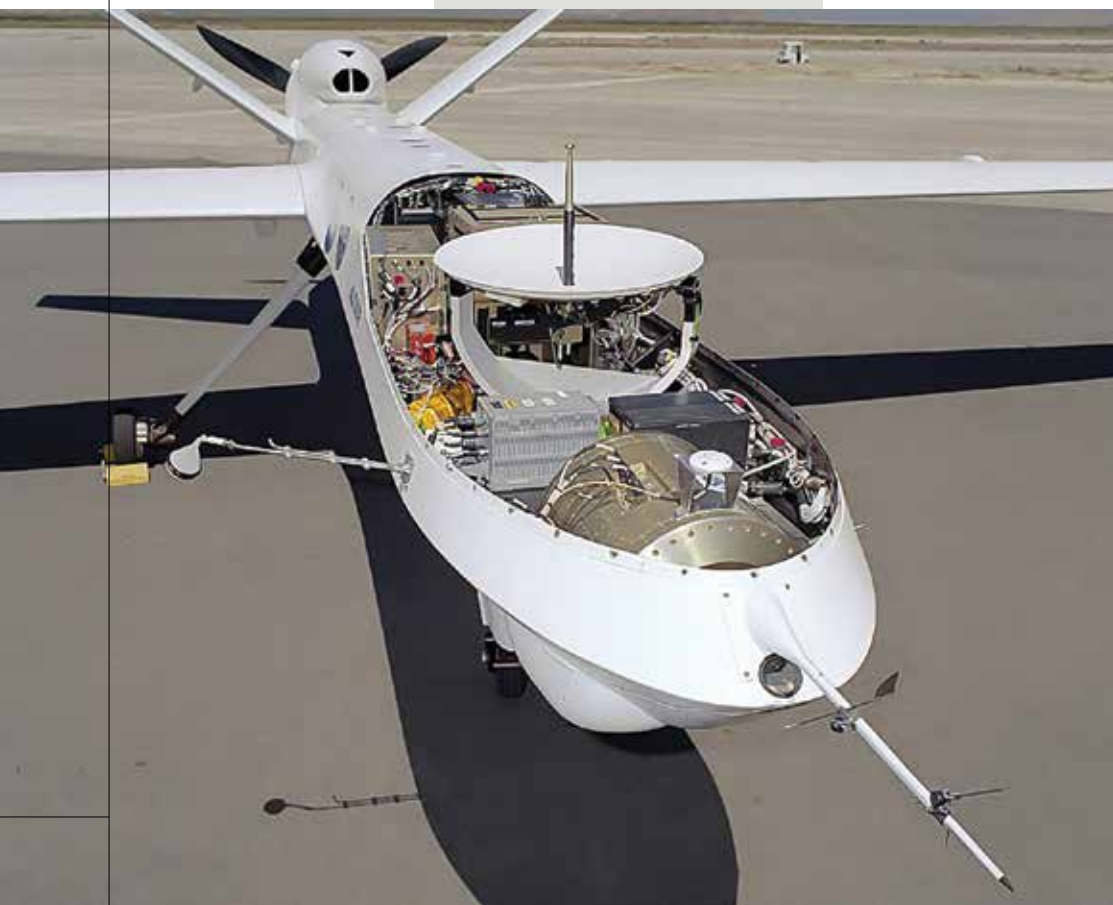
Сателитска антена и сет електрооптичких сензора летелице MQ-9 Reaper
