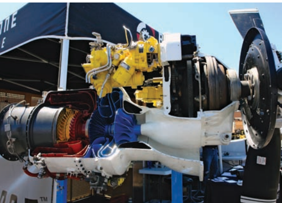
Турбоелисни TPE-331 са центрифугалним компресором нарочито опшорним на усисане чесице. Елиса се покреће посредством редуктора и није у оси мотора. Овакво решење обезбеђује уградњу централно монтираног мишраљеза или шоба који гађа кроз обртно поље елисе попут ловаца из Другог светског рата.
