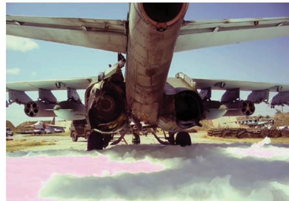
Слично оштећење мотора совјетског Су-25. Ни Су-25 ни А-10 нису довољно рентабилни у прошивничким акцијама.
